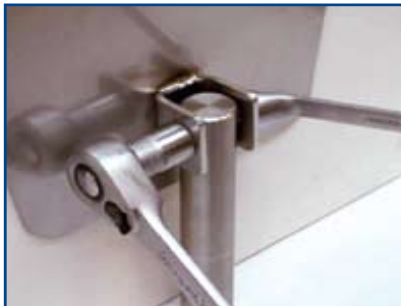
Monteer de lageras met bout en selflockmoer.
