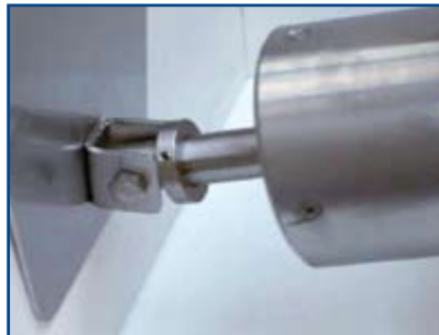
Schuif de buis over de lageras.
