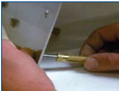
Eerst de wecopluggen op de bouten met revetten draaien.
