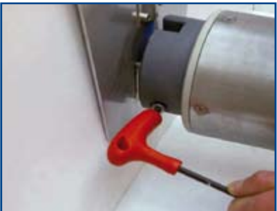
Plaats de bout en fixeër deze met de dichte moer.
