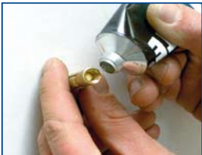
TIP! Een beetje vet aan de binnenzijde van de wecoplug aanbrengen voorkomt stroppen van de bout door stof.
