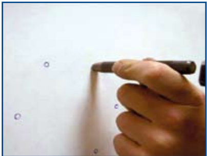
Verwijder de folie met een doorslag van \varnothing 8 mm.
