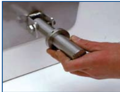
Plaats de overschuifring over de lageras en schuif deze door tot tegen het U-profiel.
