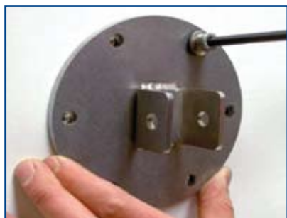
Zet de flens voor de blinde zijde vast met de korte M8 bouten met neopreenringen.
