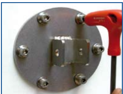
Vervolgens de bouten goed aandraaien.
