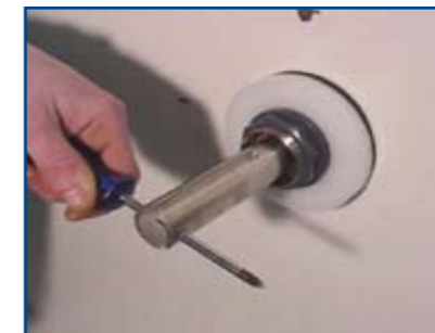
TIP! Gebruik boorgat bij spiebaan om as te manoeuvreren.
