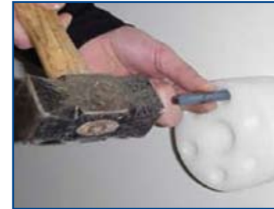
Met doorslag tapbouten volledig in kamer brengen.
