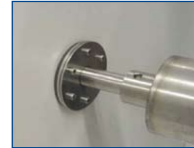
Aandrijfjas in koppelbus van buis schuiven.
