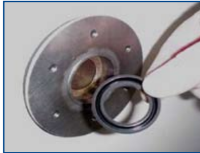
Plaats waterkering met open zijde naar het bad.
