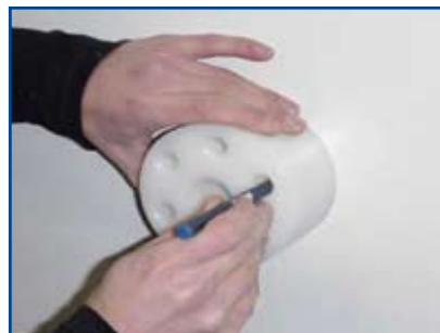
Plug invoeren lager plaatsen en andere gaten overnemen.
