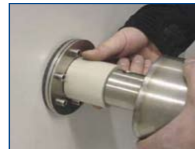
Aandrijfjas terughalen en afstandsbus tussen plaatsen en fixeren met M10 bout.
